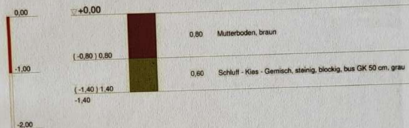
Abb. 25: Baggerschurf 5 (BS5) Bodenprofil Sohle blockig, mit Bagger nicht lösbar, trocken
