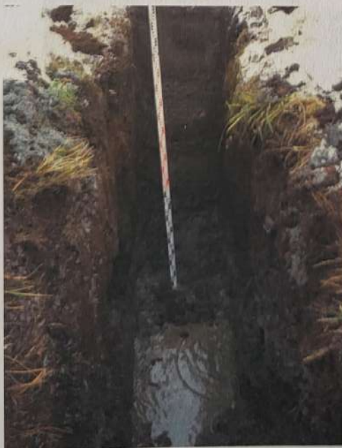
Abb. 09: Baggerschurf 1 (BS1) Bodenprofil Torf entwässert stark über die Flanken
