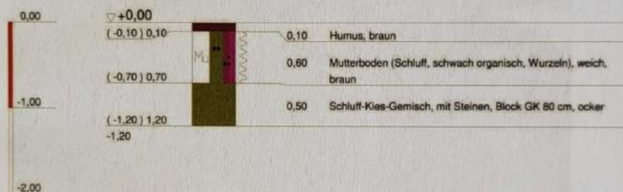
Abb. 13: Baggerschurf 2 (BS2) Bodenprofil Sohle blockig, mit Bagger nicht lösbar, trocken
