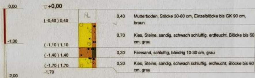
Abb. 21: Baggerschurf 4 (BS4) Bodenprofil
