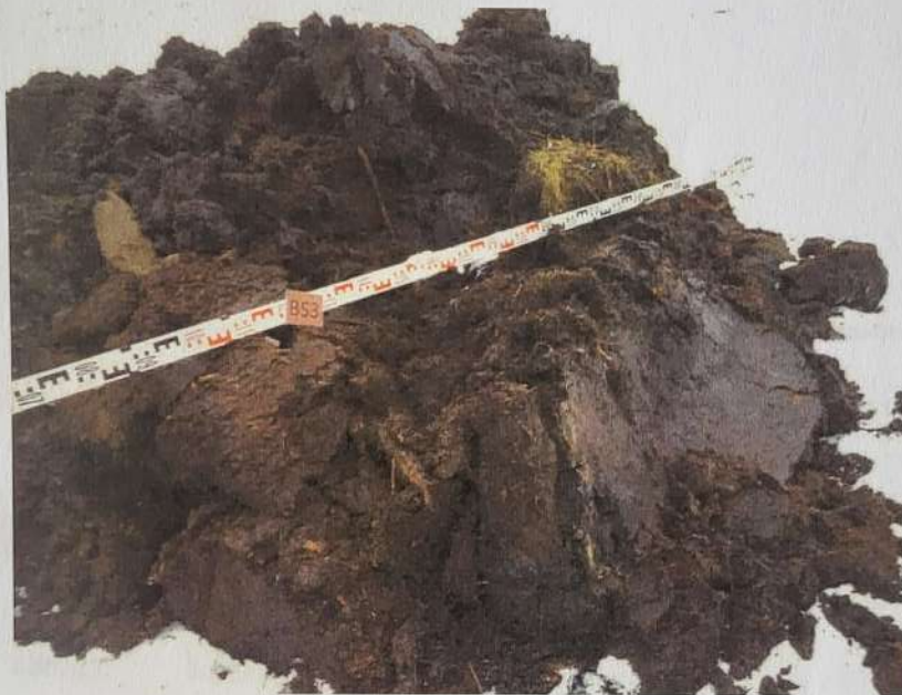
Abb. 19: Baggerschurf 3 (BS3) Auswurf: Torf
