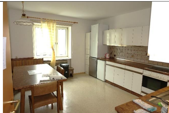
Küche: Boden: Kunststoffbelag; Wände: Tapeten; Decke: Raufaserputz; ZUBEHÖR: eine L-förmige Einbauküche mit Unter- und Oberschränken; Fronten und Arbeitsplatten beschichtet; Einbauten: 1 Edelstahlspüle mit Armatur, 1 Elektroherd mit Backrohr und Ceranfeld, 1 Dunstabzug, 1 Geschirrspüler; geschätztes Alter der Einbauküche 20 bis 30 Jahre und somit ohne Verkehrswert;
