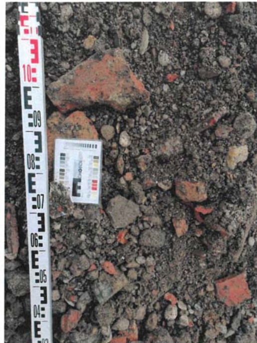
Bild 2: Detailansicht des untersuchten Materials aus Schurf „S1“ – Entnahmetiefe 0,4 – 2,7 m u. GOK
