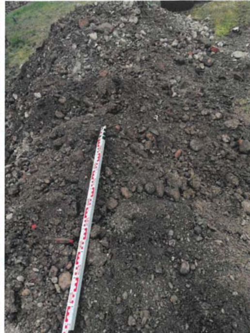
Bild 7: Detailansicht des untersuchten Materials aus Schurf „S3“ – Entnahmetiefe 0,2 – 1,5 m u. GOK
