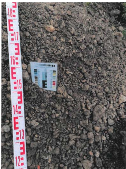
Bild 3: Detailansicht des untersuchten Materials aus Schurf „S1“ – Entnahmetiefe 2,7 – 3,0 m u. GOK
