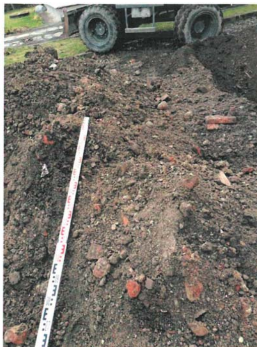
Bild 5: Detailansicht des untersuchten Materials aus Schurf „S2“ – Entnahmetiefe 0,4 – 2,4 m u. GOK
