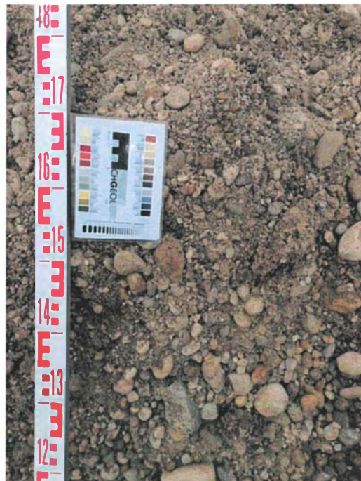
Bild 12: Detailansicht des untersuchten Materials aus Schurf „S5“ – Entnahmetiefe 0,4 – 1,2 m u. GOK
