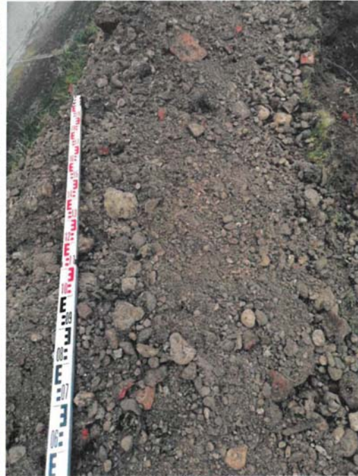
Bild 14: Detailansicht des untersuchten Materials aus Schurf „S6“ – Entnahmetiefe 0,3 – 2,0 m u. GOK
