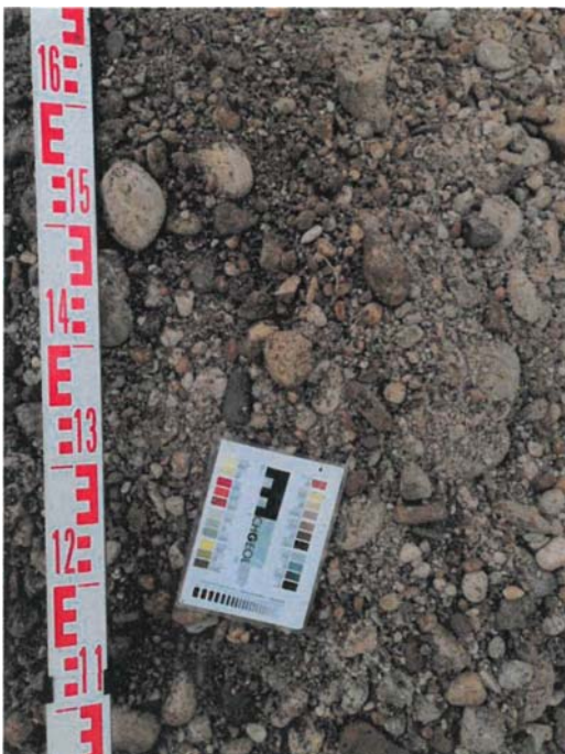
Bild 8: Detailansicht des untersuchten Materials aus Schurf „S3“ – Entnahmetiefe 1,5 – 2,3 m u. GOK
