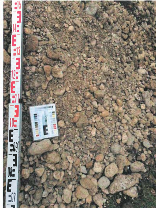
Bild 10: Detailansicht des untersuchten Materials aus Schurf „S4“ – Entnahmetiefe 0,1 – 1,2 m u. GOK
