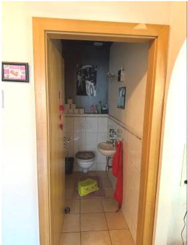
Links gelangt man durch die Futterstocktüre in das Bad, in dem ein diagonaler hellbeiger Fliesenboden verlegt ist. Die Wände sind bis zur Decke mit weißen rechteckigen Fliesen verkleidet. Auf halber Höhe ist eine umlaufende Bordüre eingebaut.
