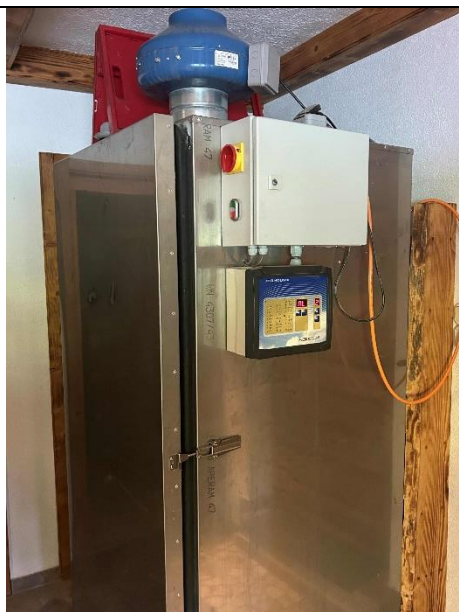
Dörrschrank, verwendet für die Trocknung der selbsterzeugten Nudeln
